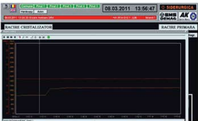
Fig. 7 Evoluția debitului de răcire primară în momentul apariției unei fisuri
