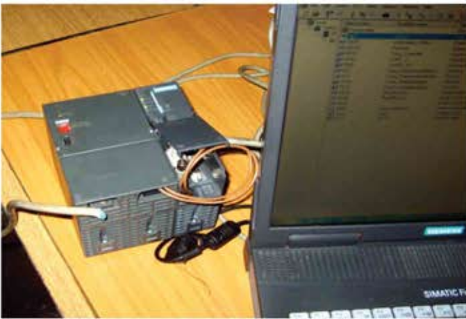
Fig. 5 Încărcarea în PLC a configurației hardware și software utilizând o consolă de programare pe MPI
